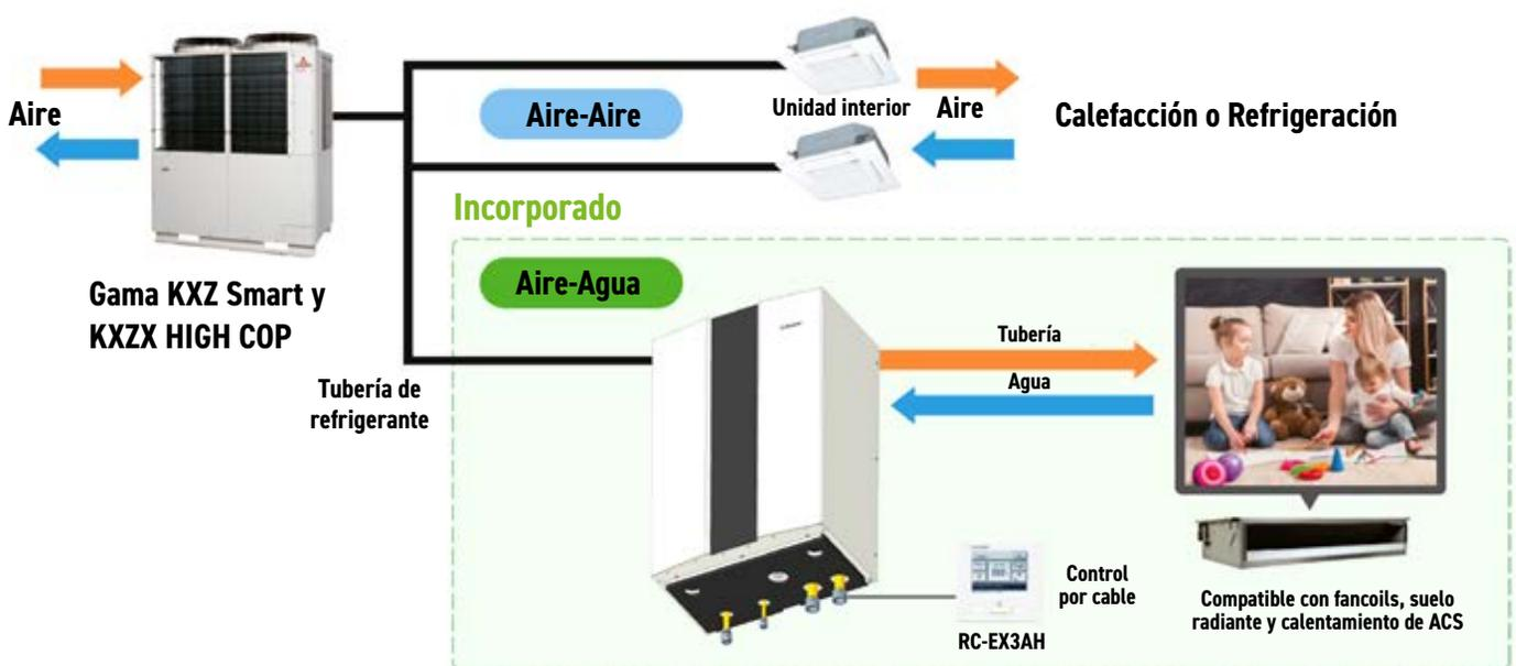
Compatible con fancoils, suelo radiante y calentamiento de ACS.
