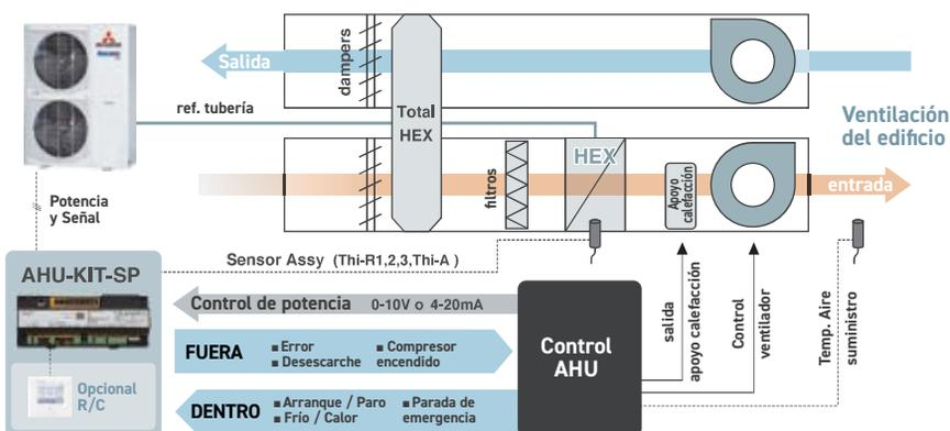
**Ejemplo 2.** El sistema AHU-KIT-SP es esclavo del sistema MODBUS presente en la instalación
