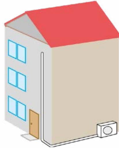
Gracias a la mejora de la longitud de tuberías es posible instalar un equipo en un edificio de tres pisos.
