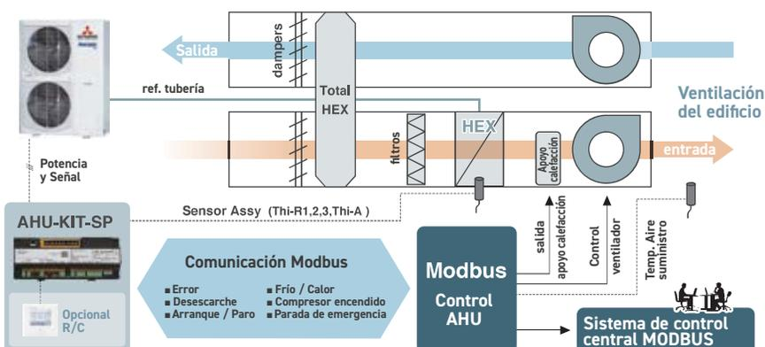
**Ejemplo 3.** El sistema AHU-KIT-SP controla el arranque / paro de los ventiladores del climatizador
